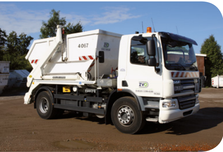
Sieben Kubikmeter Absetzcontainer u.a. für Bauabfälle.
